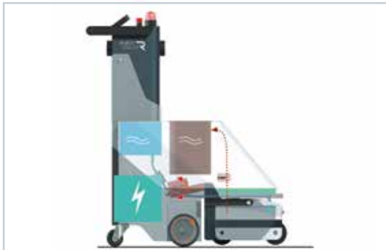
BATTERIEVERTEILUNG, MOTOR, SCHWERPUNKT, STABILE MASCHINE
